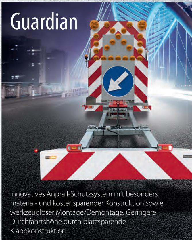
Innovatives Anprall-Schutzsystem mit besonders material- und kostensparender Konstruktion sowie werkzeugloser Montage/Demontage. Geringere Durchfahrthöhe durch platzsparende Klappkonstruktion.
